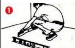
Les lames flottantes peuvent s'installer sur n'importe quelle surface plane et sèche (carrelage, ciment, grès, ...). En cas d'inégalités de niveau, il faut au préalable aplanir avec une pâte, toile asphaltique, ou simplement avec du sable. (dessin 1)
