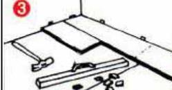
Nous conseillons de commencer par le mur le plus long de la pièce à installer. Placer une cale en bois entre le mur et la première rangée de lames, de manière à avoir une distance de 5 à 10 mm qui servira de joint de dilatation (dessin 3)
