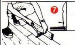
La dernière lame devant en général être coupée, mettez un morceau contre le mur au dessus du sol et utilisez ce morceau comme guide en marquant au crayon la découpe à réaliser. (dessin 6)
